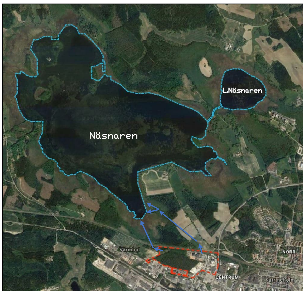
Figur 2-1. Översiktskarta över recipienten Näsnaren och dess anslutning till Lilla Näsnaren. Planområdet är markerat med röd streckad linje. De blå pilarna visar hur dagvattnet från planområdet avleds via diken till Näsnaren. (Ortofotot är hämtat från Google Earth, 2019)
