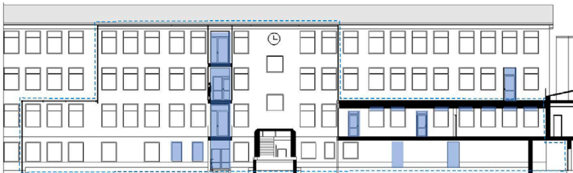
Bilden ovan är en sektion genom tillbyggnaden. Den blå färgen representerar ändringar i Tallåsskolans fasad. Den nordligaste tillbyggnaden (de två nedersta våningarna längst till höger i bild), inrymmer musiklokaler i anslutning till den befintliga aulan för samutnyttjande både under och utanför skoltid. Bottenvåningen rymmer tillagningskök och inlastning. Funktionerna medför att denna del av tillbyggnaden inte kan vara glasad.
