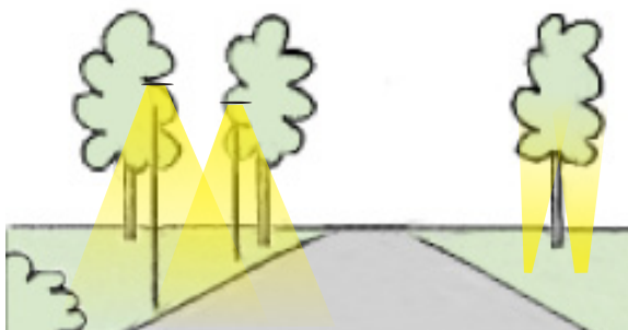
De rundstrålade parkarmaturerna ger ljus till vägen samt omgivningen. Effektbelysning på trädet är ett vackert inslag som breddar rummet.
